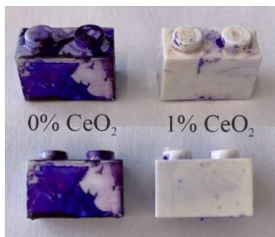
**Anwendung von CeO<sub>2</sub>-Nanopartikel (nachher).** LEGO-Stein nach Inkubation in einer Kultur von *P. aeruginosa*. Die Bakterien sind violett angefärbt. Nach 72 Stunden zeigten die Bausteine, die mit Lack ohne CeO<sub>2</sub>-Nanopartikel behandelt sind, einen starken Bakterienbelag, die Bausteine mit CeO<sub>2</sub>-Lack dagegen nicht. Quelle: Tremel Forschungsgruppe, JGU
