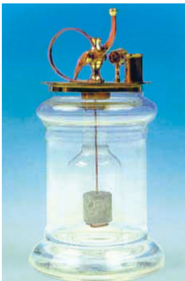
Abb. 1 Döbereinersches Feuerzeug. Das Zinkstück im Zentrum wird mit Schwefelsäure in Verbindung gebracht, die sich im Glaszylinder befindet. Der entstehende Wasserstoff entzündet sich an einem Platinschwamm.
